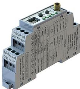
Радиомодем РМ-868 представляет собой устройство для приема и передачи данных по радиоканалу со скоростью 1200, 2400, 4800, 9600, 19200, 38400 бод в диапазоне частот 868.7-869.2 МГц при выходной мощности до 25 мВт, что позволяет использовать данное устройство без получения разрешения радиочастотной службы при Федеральном агентстве связи.
