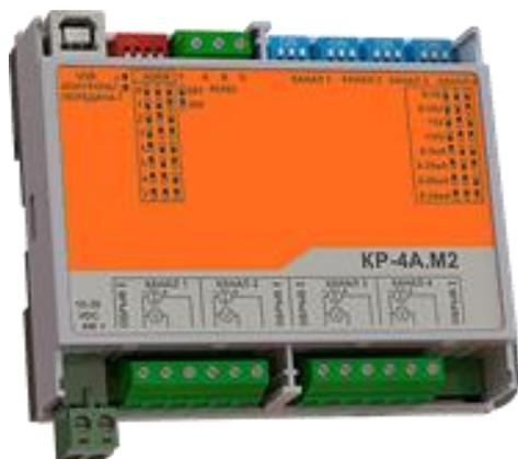
КР предназначен для функционирования в информационно-управляющих системах (АСУТП, SCADA-системы, системы автоматизированного коммерческого учета энергоносителей, системы телемеханики и т.п.) в качестве устройства дистанционного управления и взаимодействия с более высокими уровнями систем, в том числе ПЛК-84.М2, ПЛК166.М2, ТК-166.02, ТК-84.М1.
