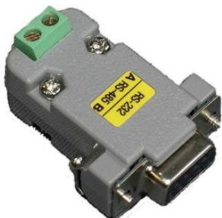
Адаптер последовательного канала A232/485 с гальванической развязкой (далее - адаптер) предназначен для преобразования интерфейса RS232 в интерфейс RS485. Применяется для организации локальной сети при использовании с вычислителями УВП-280.
