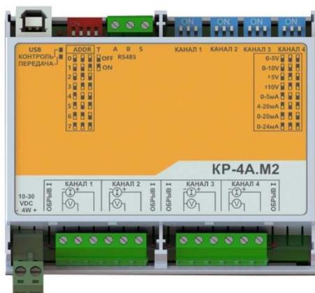
КР предназначен для функционирования в информационно-управляющих системах (АСУТП, SCADA-системы, системы автоматизированного коммерческого учета энергоносителей, системы телемеханики и т.п.) в качестве устройства дистанционного управления и взаимодействия с более высокими уровнями систем, в том числе ПЛК-84.М2, ПЛК166.М2, ТК-166.02, ТК-84.М1.
