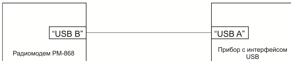
Рис. 6 Схема подключения радиомодема по интерфейсу USB
