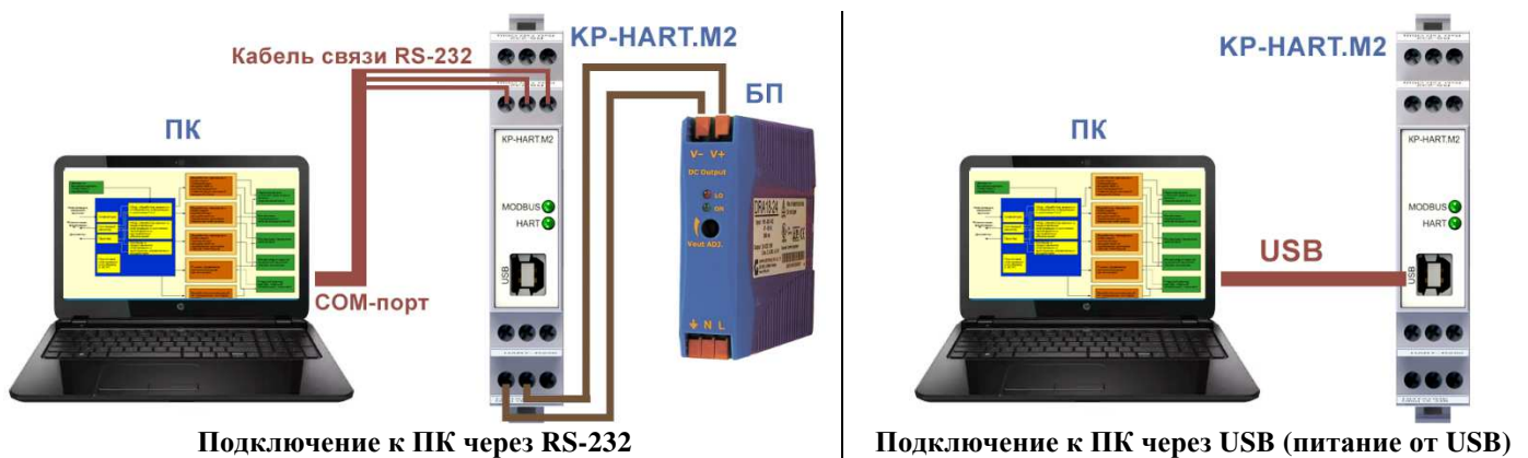
Рис.2.Схемы соединения контроллера и ПК (контроллера верхнего уровня)
