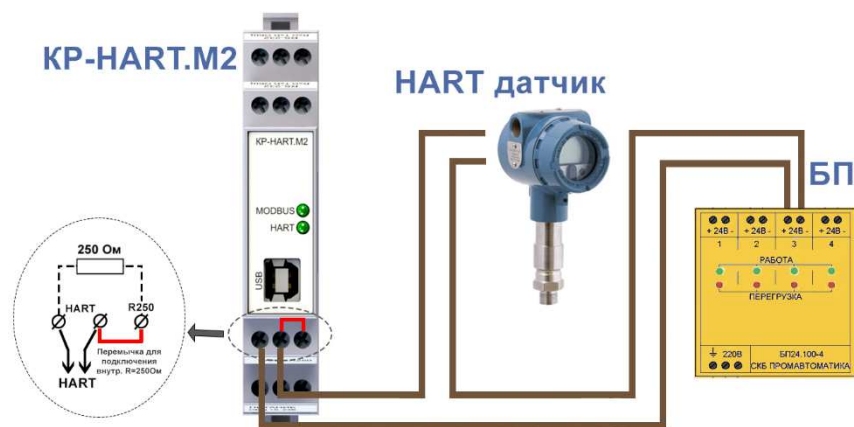
Рис.5. Подключение HART устройства с использованием внутреннего резистора 250 Ом
