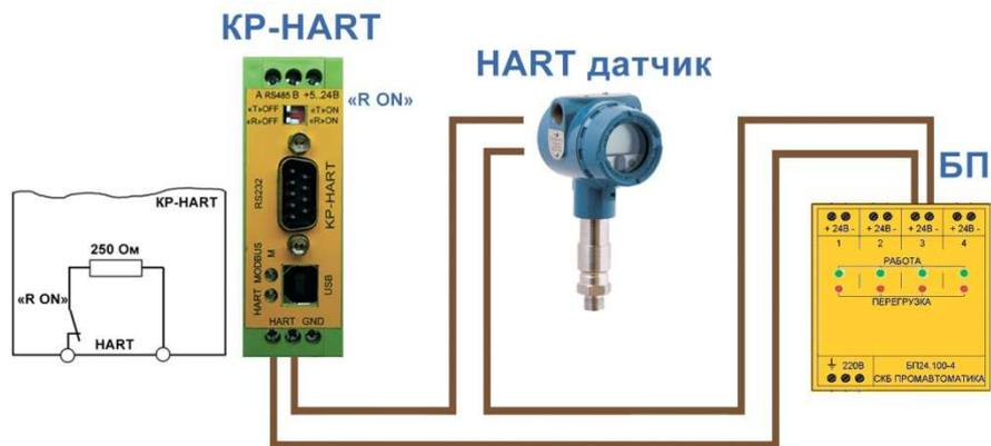
Рис.4. Подключение HART устройства с использованием внутреннего резистора 250 Ом
