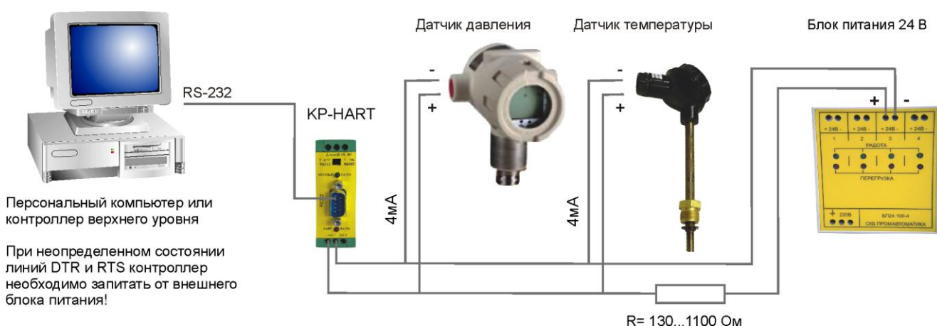
Рис.2.Схема соединения датчиков, контроллера (с использование выхода RS-232) и ПК (контроллера верхнего уровня)
