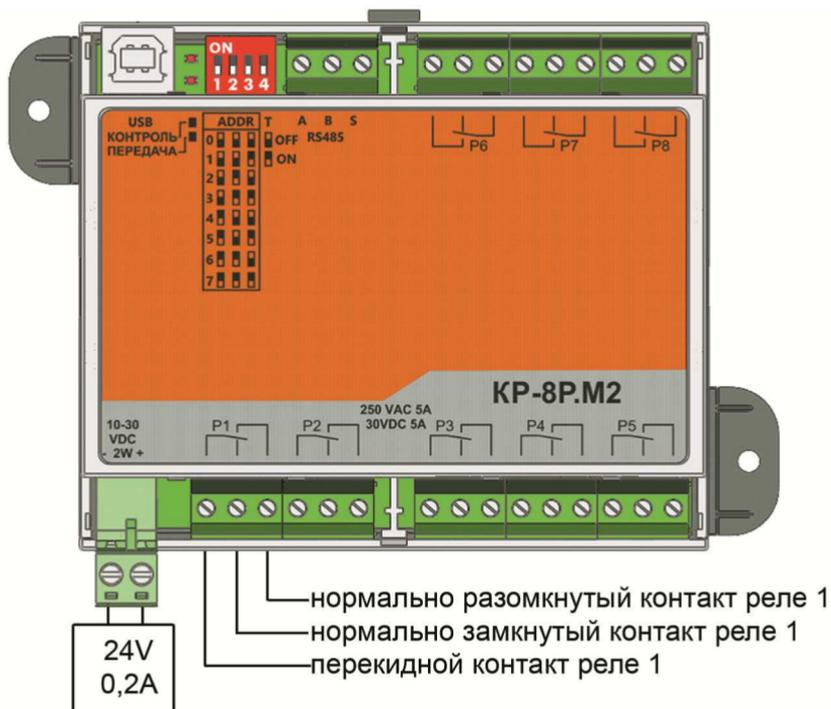
Рис.4 Подключение цепей питания и сигналов управления КР
