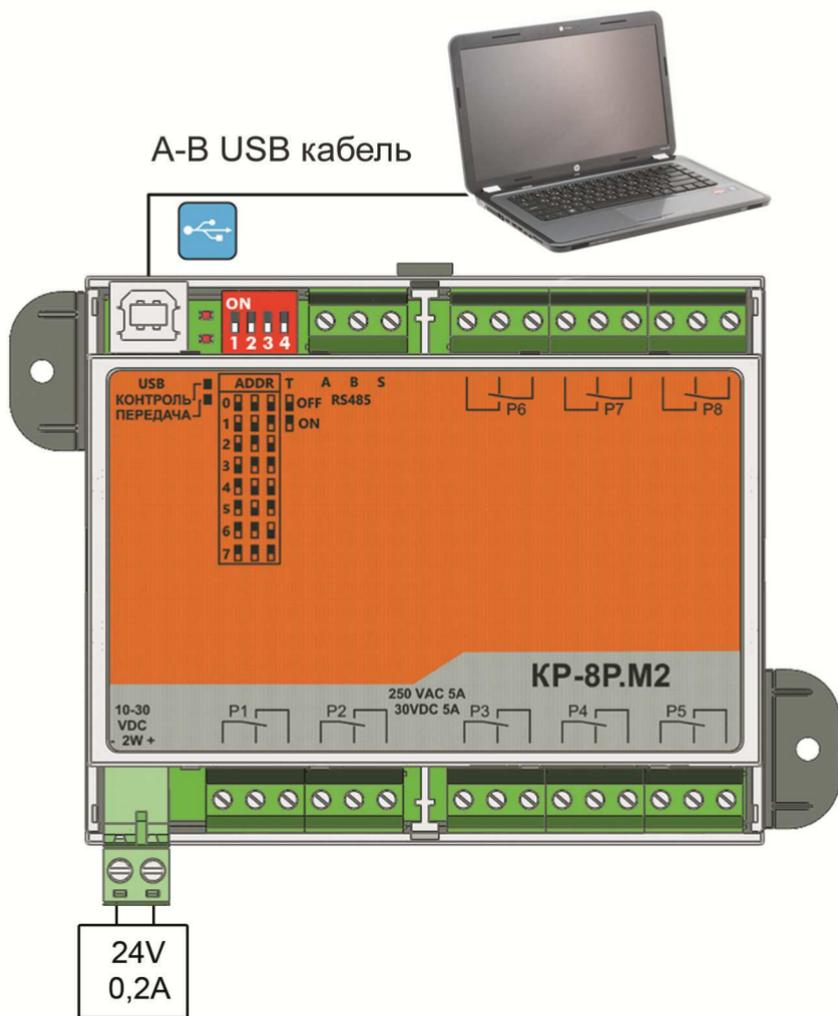
Рис.5 Подключение КР к компьютеру при изменении настроек
