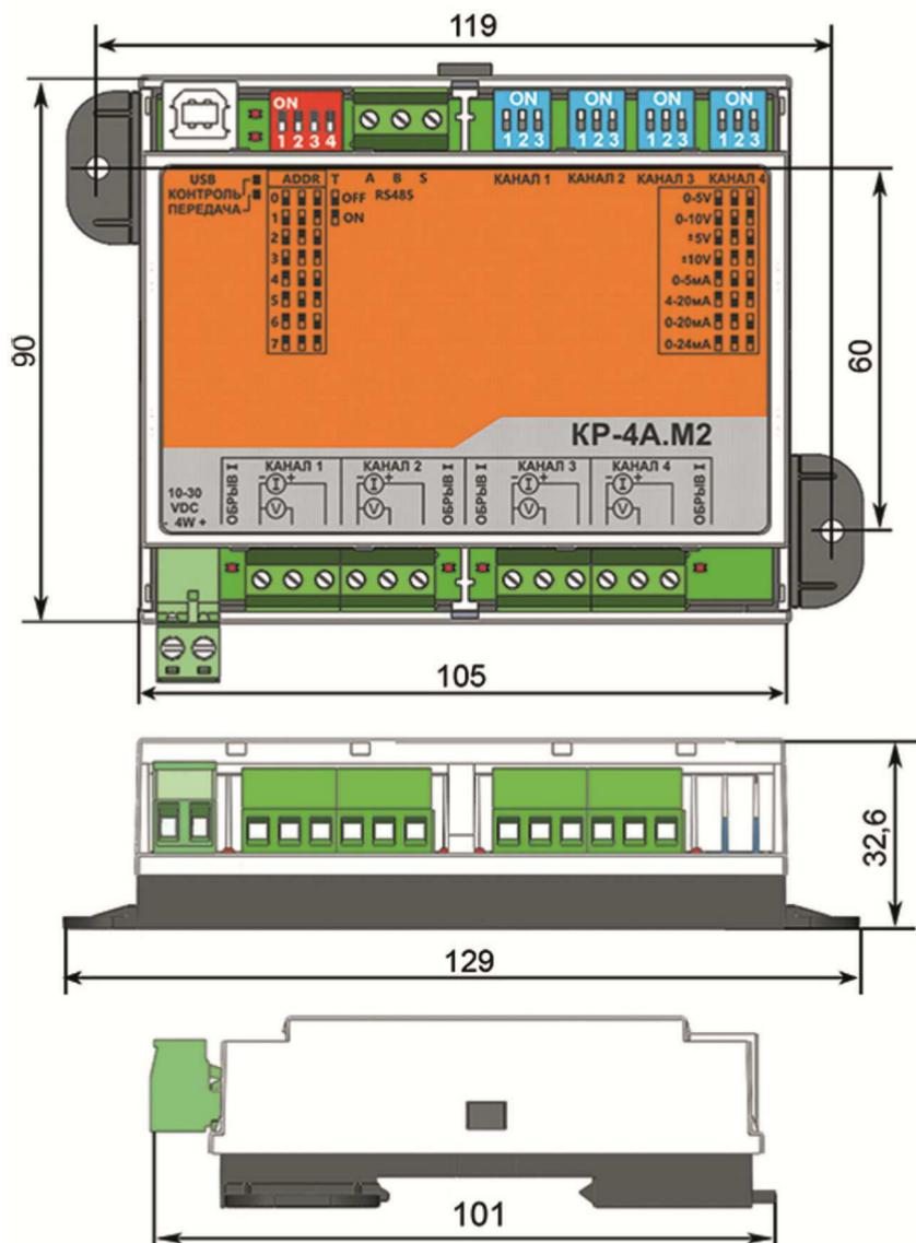
Рис.1 Габаритно-присоединительные размеры КР.
