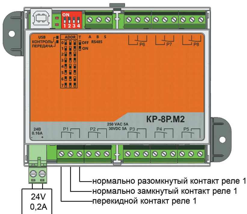
Рис.4 Подключение цепей питания и сигналов управления КР
