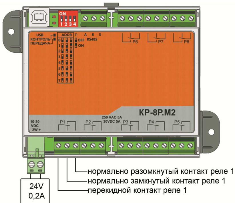
Рис.4 Подключение цепей питания и сигналов управления КР
